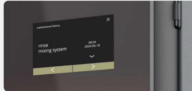
Un historial de mantenimiento registra cuándo se ha lavado, descalcificado o sustituido el filtro de agua del aparato.
